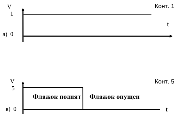
Рис.3. Диаграммы импульсов и напряжений на разъеме X8 блока управления.
