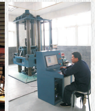
500T高精度全自动叠加式力标准机
